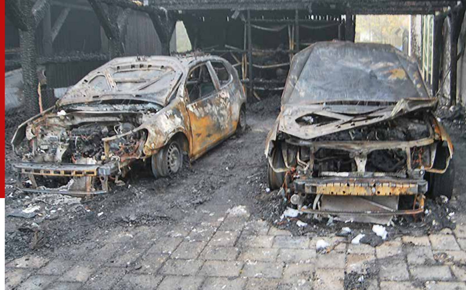
Beim Brand der Fahrzeuge entwickelte sich eine große Hitze. Der Abstand zur Fassade reichte nicht aus, um ein Überspringen des Feuers zu verhindern
